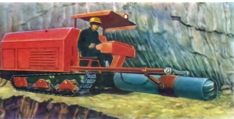
Буровой станок для бурения скважин большого диаметра с алмазным инструментом. Вверху — схема исполнительного органа станка.
