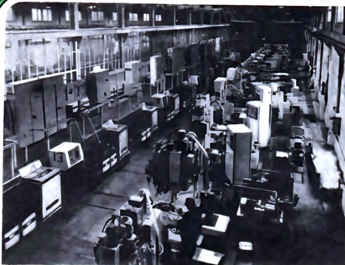
Автоматизированный участок АУ-1 для комплексной обработки деталей типа тел вращения, действующий на московском заводе «Станкоконструк-
