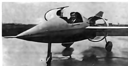
Один из потомков «небесной блохи». Самолет оснащен 100-сильным двигателем «Континенталь». Воздушный винт окружен кольцом, которое улучшает характеристики пропеллера. Скорость машины превышает 350 км/ч.
