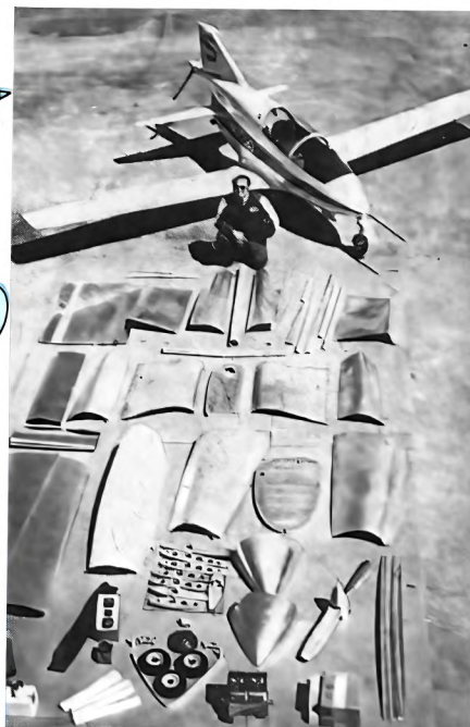
Цельнометаллический самолет простейшей, «схематической» конструкции. Изготавливается любителями из полуфабрикатов, высылаемых в виде комплектов.
