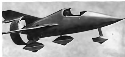
Один из потомков «небесной блохи». Самолет оснащен 100-сильным двигателем «Континенталь». Воздушный винт окружен кольцом, которое улучшает характеристики пропеллера. Скорость машины превышает 350 км/ч.
