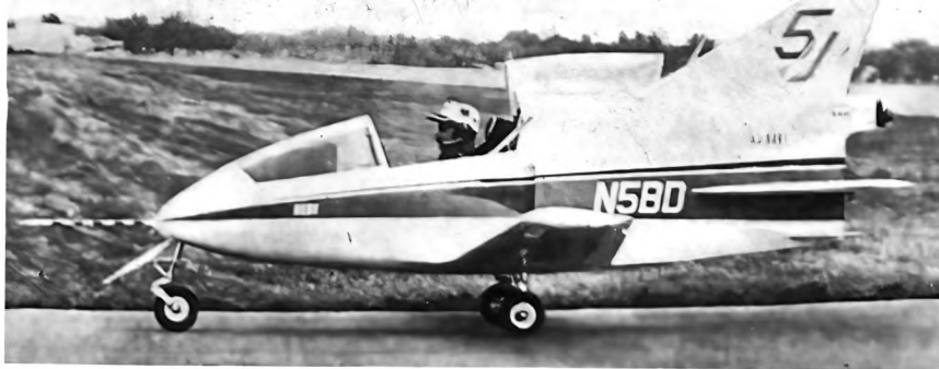
Реактивный мини-самолет БД-5 американского конструктора Джеймса Беде. Скорость машины превышает 500 км/ч. Винтовой предшественник реактивного БД-5 «Микро». На снимке показаны и основные конструктивные элементы этого удачного самолета.
