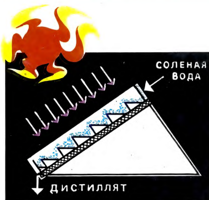
Рис. 2. Простейшая опреснительная ступенчатая установка.
