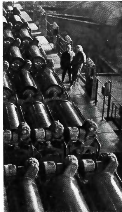
Установка для непрерывного литья при производстве алюминиевой ленты на заводе в Нахтерштедте разработана совместно учеными и инженерами ГДР и СССР.
