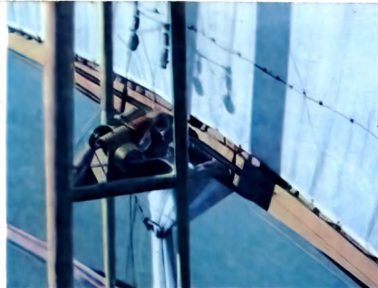
Электромотор, приводящий в движение механизм установки парусов «Дайнашиффа».
