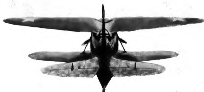
2. «Моно-биплан» В. Шевченко в варианте однокрылого и двухкрылого истребителя (1940).
