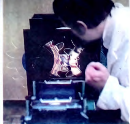
Прибор для определения напряжений методом фотоупругости. На экране — изображение модели зубчатого зацепления.
