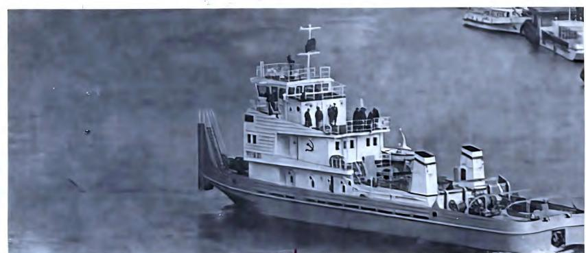
Шестистольный дизельный буксир-толкач серии «Объ» Тюменского судостроительного завода прошел ходовые испытания и сдан в эксплуатацию. Теплоход создан для работы на реках Западной Сибири, в нефтегазодобывающих районах Севера. Он имеет автоматизированное управление, оснащен современным навигационным оборудованием, обладает высокой скоростью и маневренностью, способен водить составы барж с грузом от 3 до 5 тыс. т. Осадка буксира не превышает 1,3 м.
