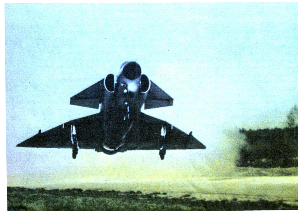
Шведский истребитель СААБ-37 «вигген». Машина построена по схеме «Утка» — оперение расположено впереди крыла.
