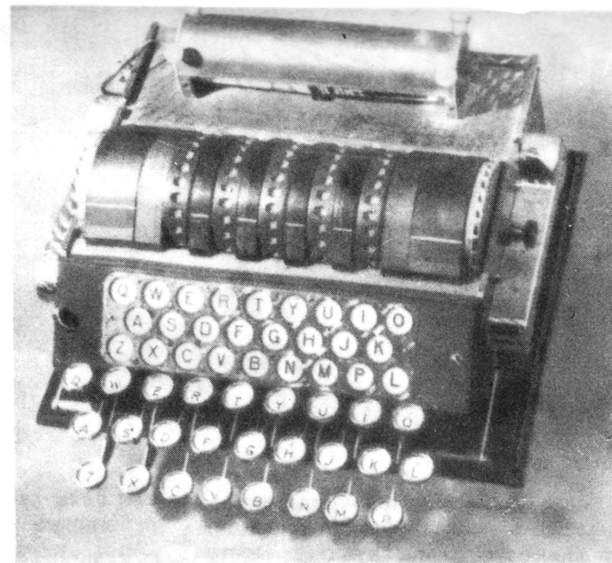
Рис. 1. Криптографическая машина Бориса Хагелина, изобретенная в 1934 году. Она проще роторной и почти так же надежна. Ключ устанавливается с помощью шести шестеренок и барабана. Шифровальный алфавит «привязан» к тому или иному набору позиций механизма.
