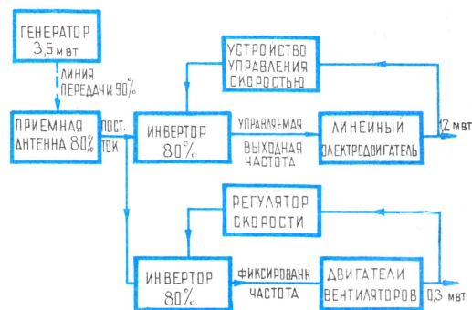
Блок-схема энергетической установки аэропоезда. Инвертор преобразует постоянный ток в переменный.
