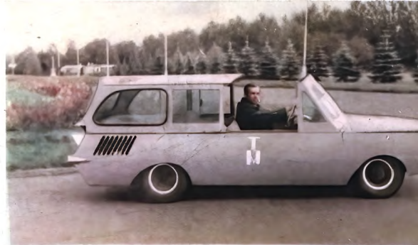
У автомобиля В. Бойко (г. Дубна) по-самолетному откидывается верх кабины.
