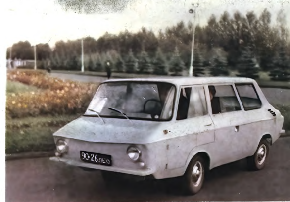
Стеклопластик становится популярным материалом для кузовов машин-самodelок. Его замечательные свойства позволили ленинградцу Г. Федорову создать этот «микроавтобус».
