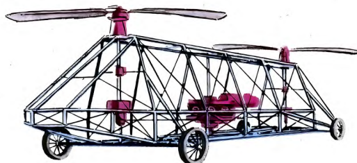
Проекты многовинтовых вертолетов. Среди реализованных винтокрылая машина с двумя тандемно расположенными винтами. Такой компоновкой отличались советский вертолет ЯК-24 и многие машины американских конструкторов.
