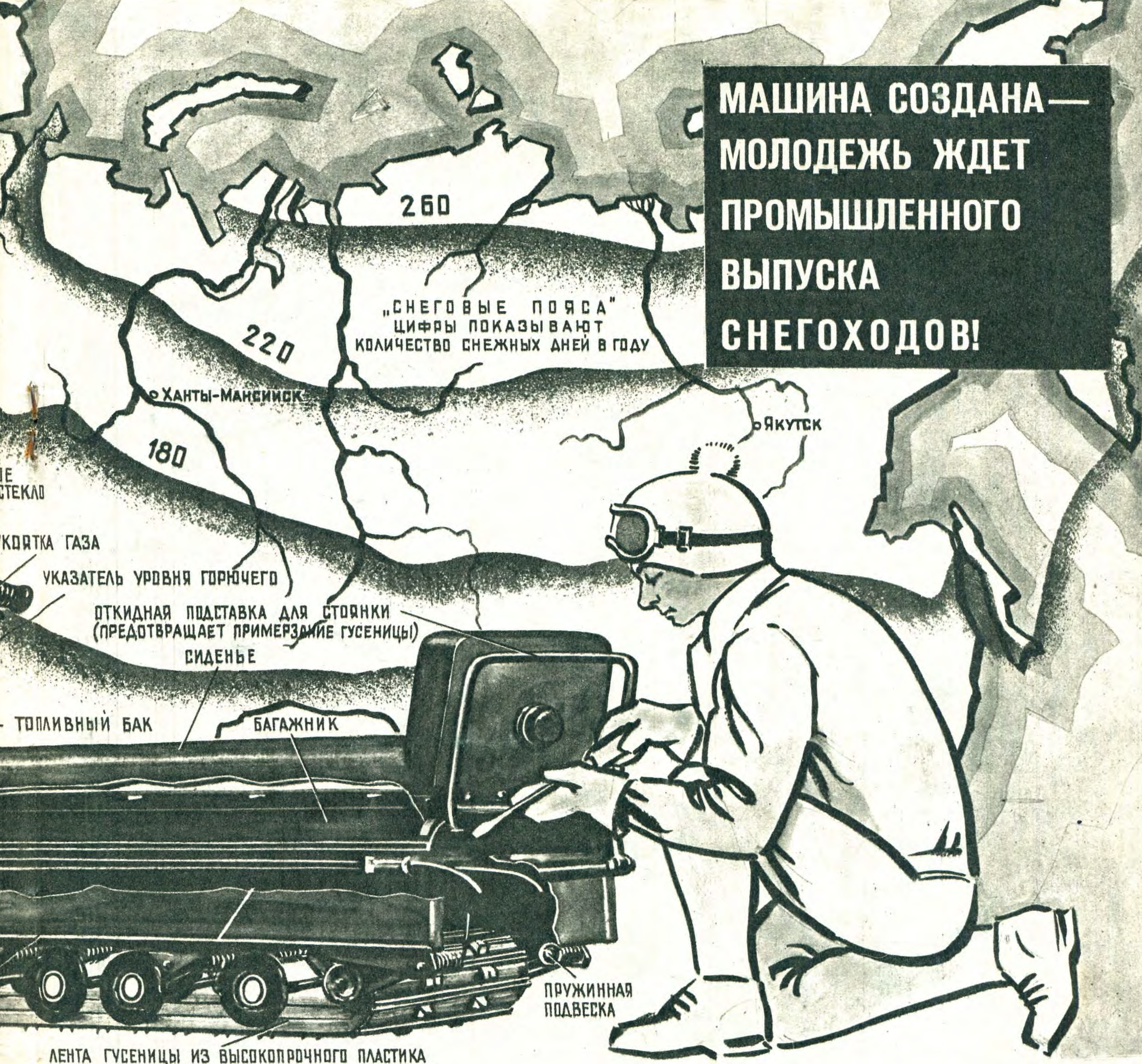
СНЕГОХОД „ЭВИНРУД“ (в разрезе)
