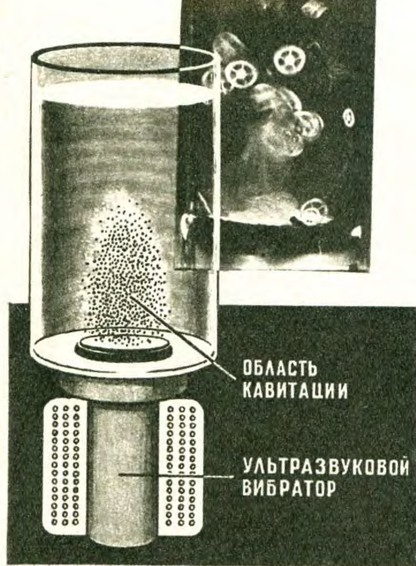
Рабочий цилиндр станка для кавитационного удаления заусенцев с деталей.
