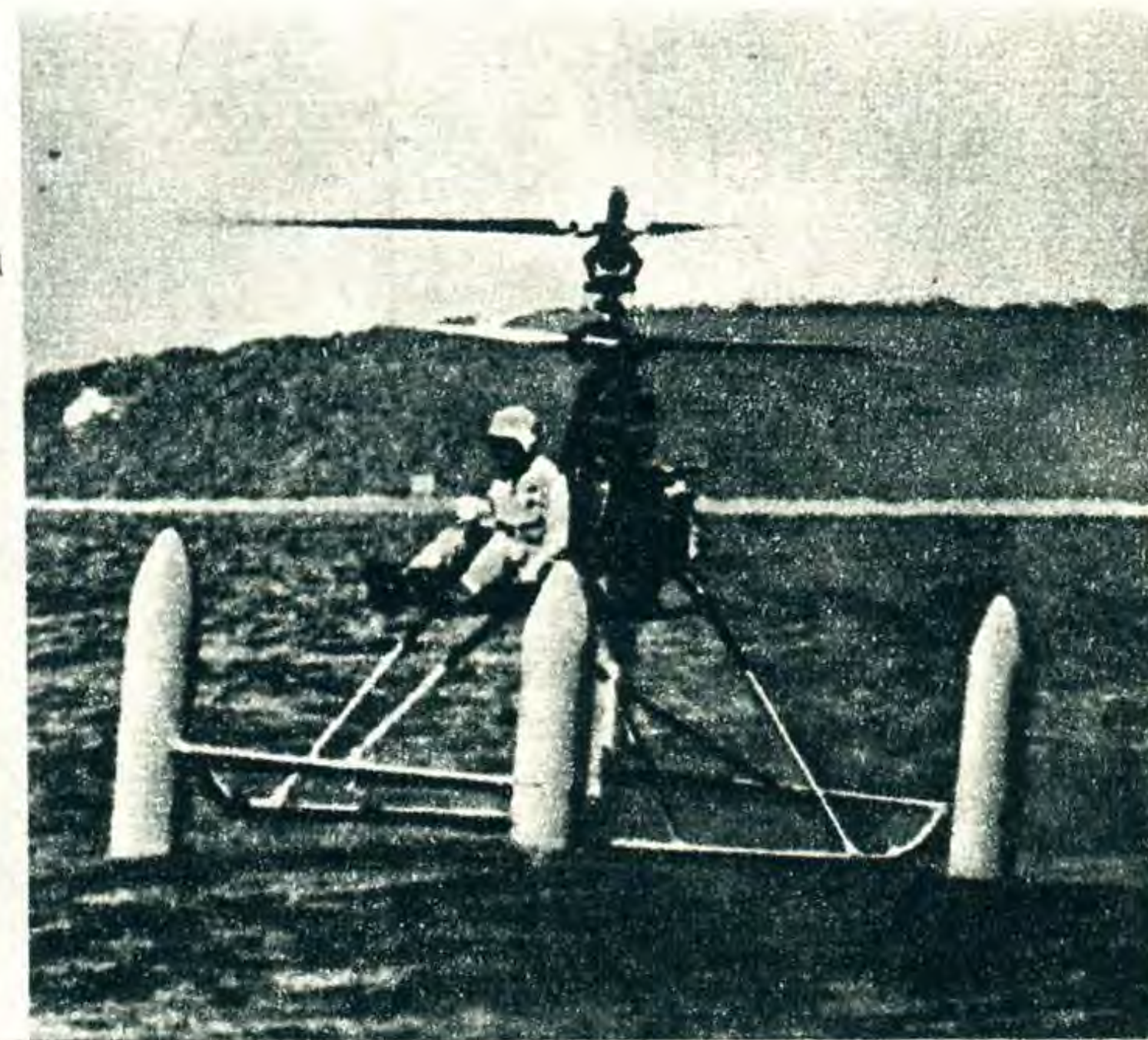
Поплавки, занимающие при посадке вертикальное положение, дают возможность вертолету «приводниться» даже при сильном волнении на море.
