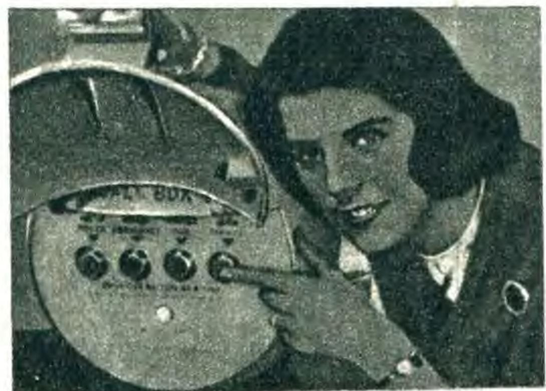
**КОРОБКА ЭКСТРЕННОГО ВЫЗОВА.** На главных автомобильных магистралях штата Мэриленд установлены автоматические коробки для срочного вызова полиции, санитарной машины, пожарной команды или технической помощи. Для этого достаточно нажать одну из четырех кнопок, помещающихся на табло под крышкой коробки (США).
