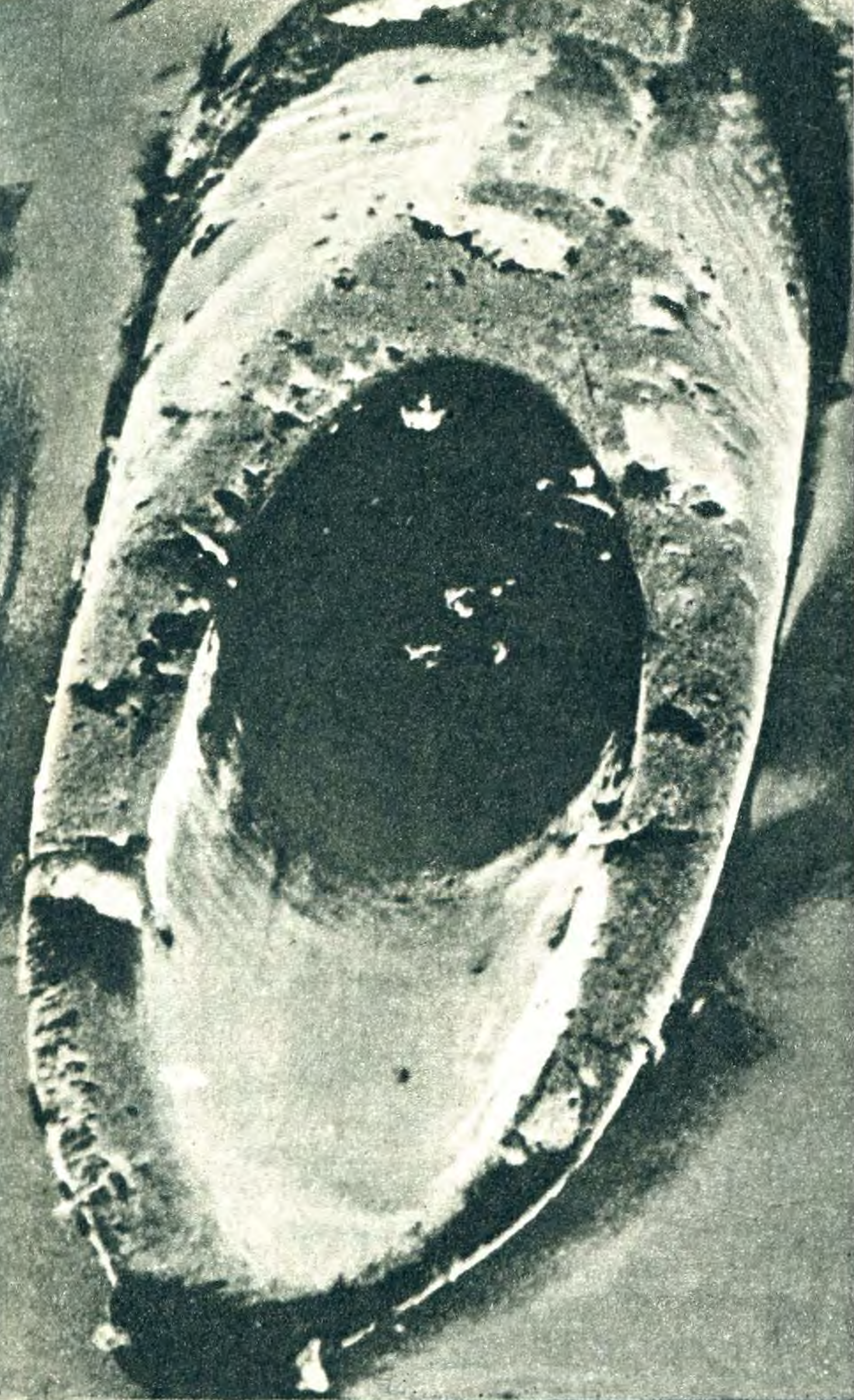
Рис. 1. Так выглядит на экране нового электронного микроскопа при увеличении в 6300 раз кончик иглы шприца, извлеченной из тела больного. Видны прилипшие к нему частицы тканей тела.
