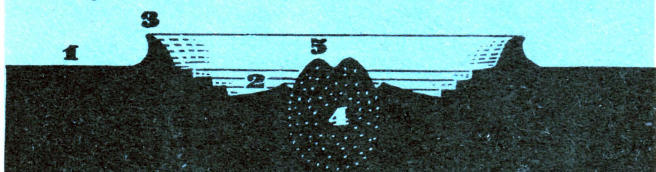
1-поверхность пластинки. 2-кратер. 3-валик кратера. 4-зона расплавленной среды. 5-центральный вулкан.
