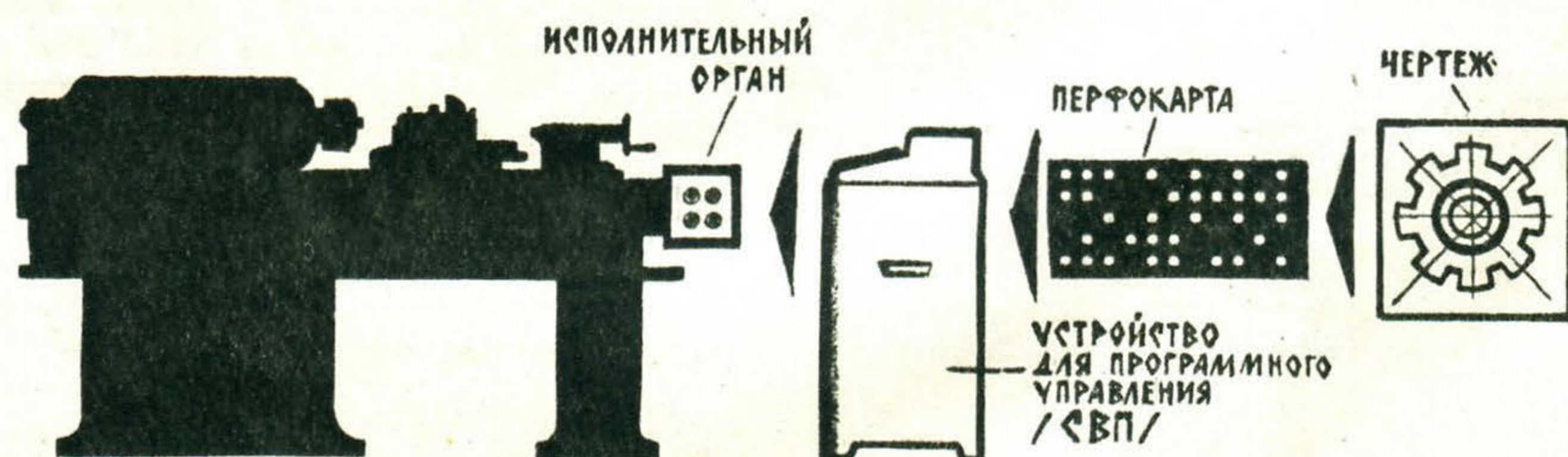
Устройство программного управления станками для автоматизации цикла универсальных токарных станков.
