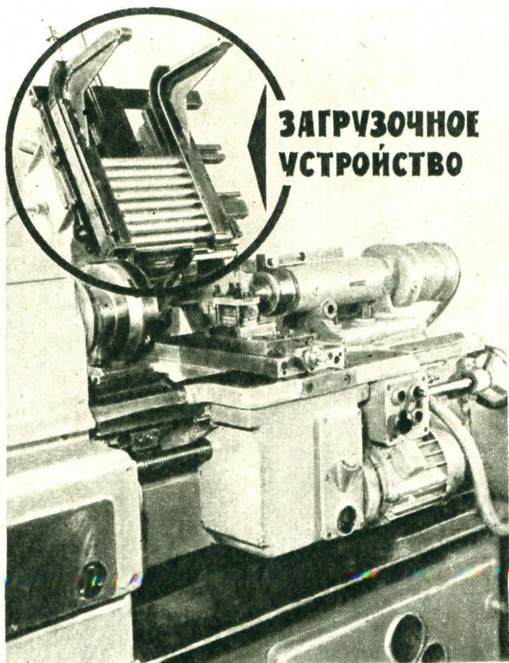
Магазинное загрузочное устройство к токарному станку.
