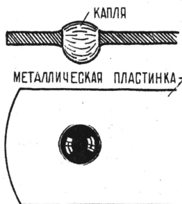
Принцип получения линзы-капли.
