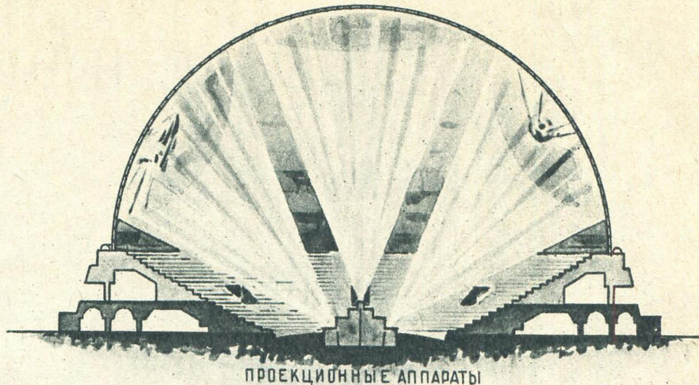
Тонкопленочный купол, поддерживаемый избыточным давлением, перекрывает стадион.
