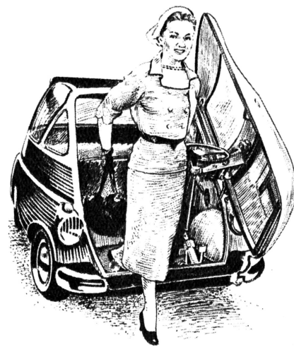
У автомобиля «изетта» дверца устроена в передней стенке.
