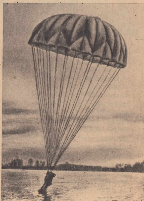
2 Коснувшись воды ногами, летчик отпускает парашют и, соскальзывая с круговой лямки парашюта, тяжестью своего тела выдергивает лодку из чехла.
