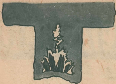
Свободно растущие кристаллы в усадочной раковине слитка.
