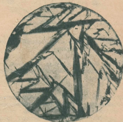
Микроструктура закаленной стали. Иглы мартенсита в аустените.
