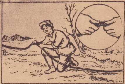
8. Это Михась, перегибая кабель несколько раз, порвал жилу внутри оплетки.
