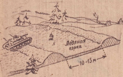
В зимних условиях, для того чтобы воспрепятствовать подходу танков противника, применяют снеговые валы и обледенение скатов.
