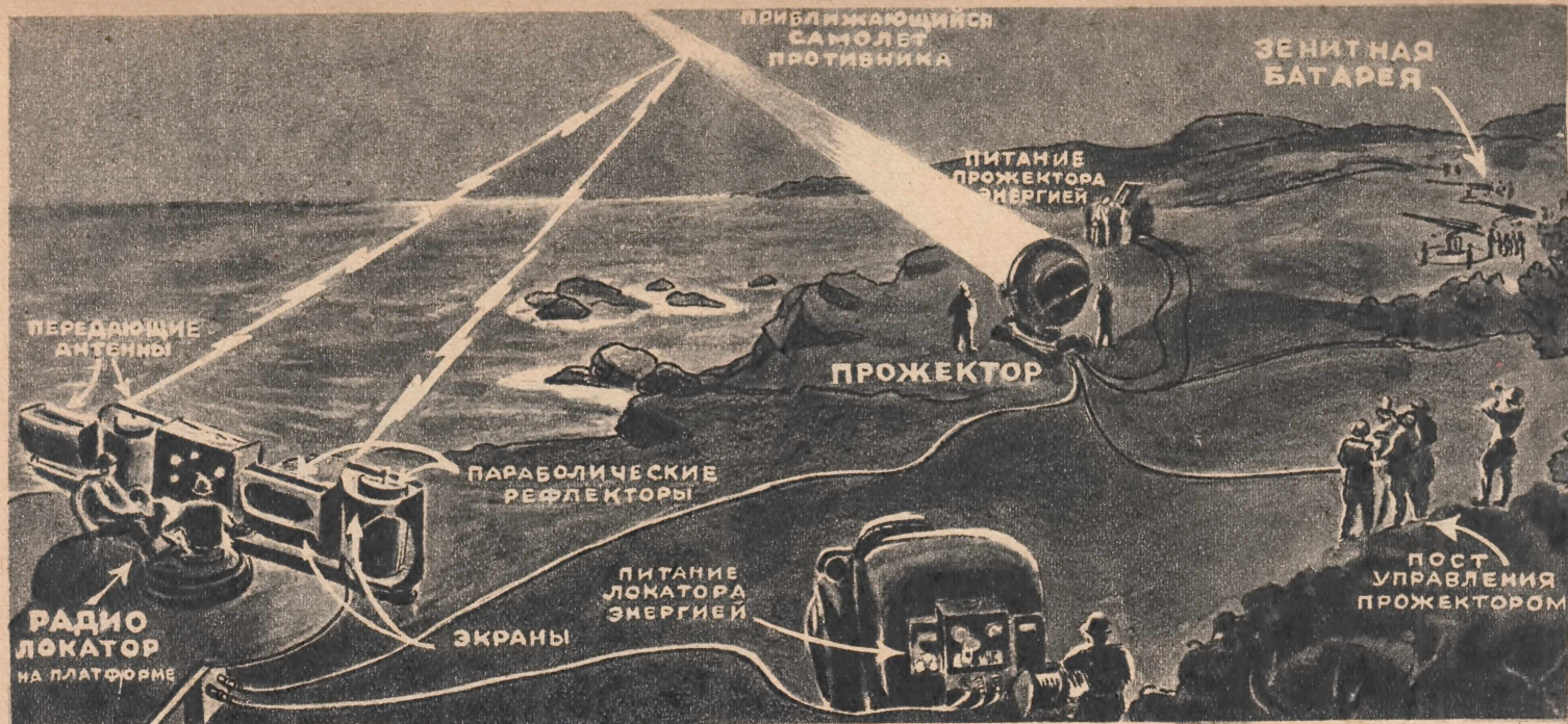
Пост управления прожектором оборудован специальными оптическими приборами, которые позволяют точно навести луч прожектора на цель.
