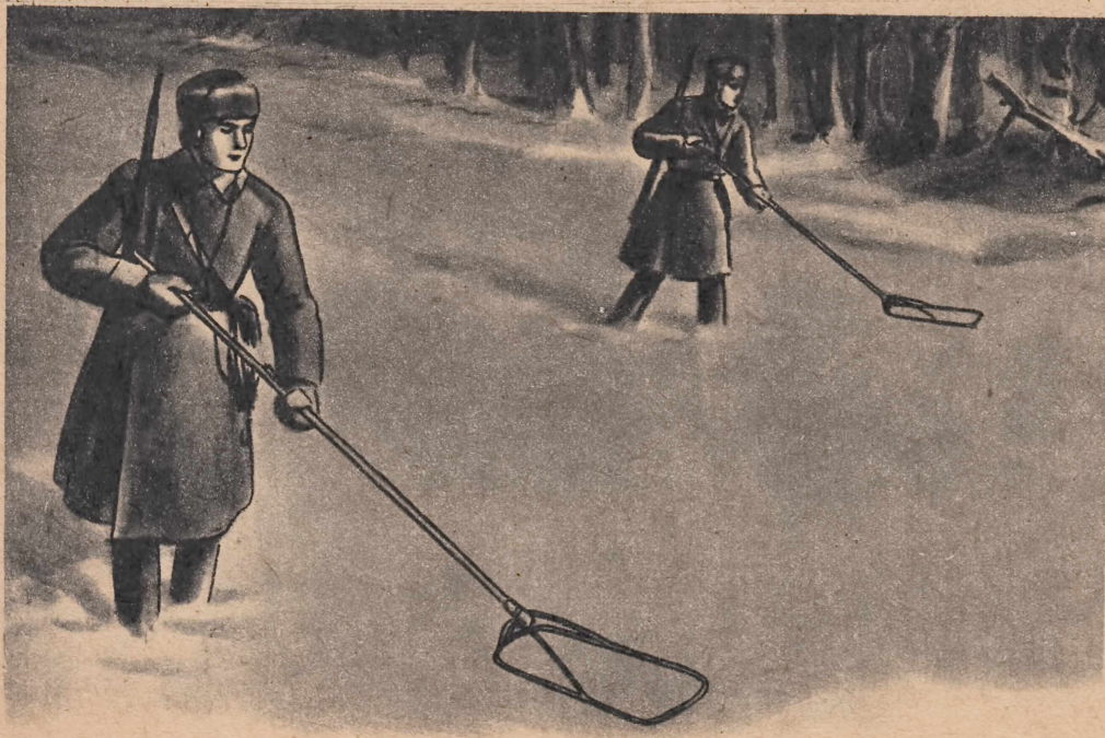
Такой миноискатель, проходя над металлической миной, моментально сигнализирует саперу о ее присутствии. Еще не было случая, чтобы он подвел наших бойцов.
