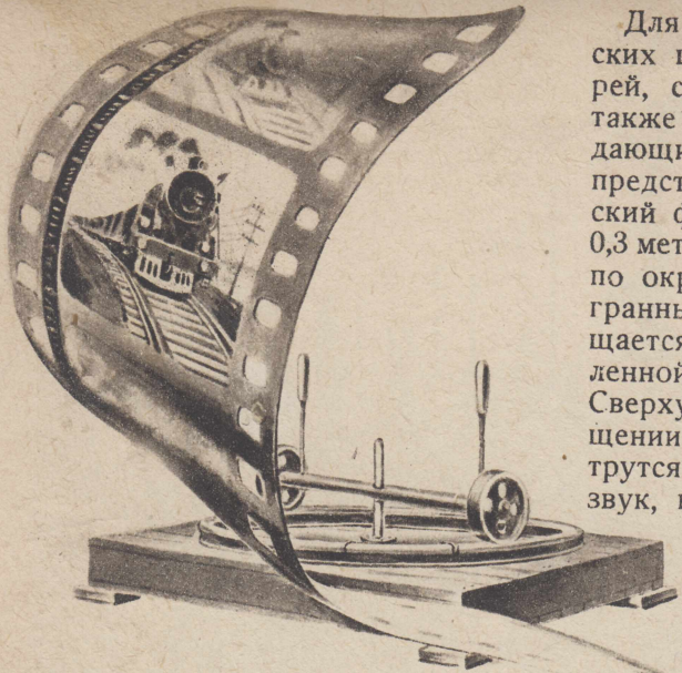
С помощью этого простого приспособления создается шум движущегося поезда.
