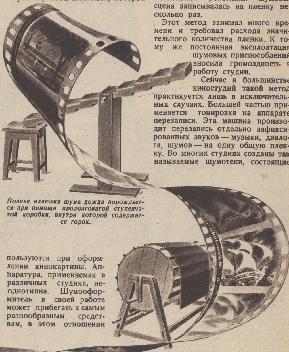
При вращении барабана грани планок трутся о ткань, порождая шум ветра.
