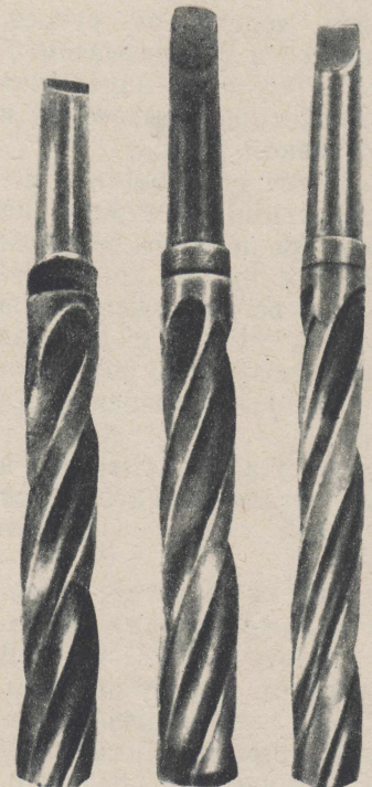
На инструмент с отломанной лапкой (слева) наваривают сталь (средний снимок). Этому приростку придают затем форму лапки.
