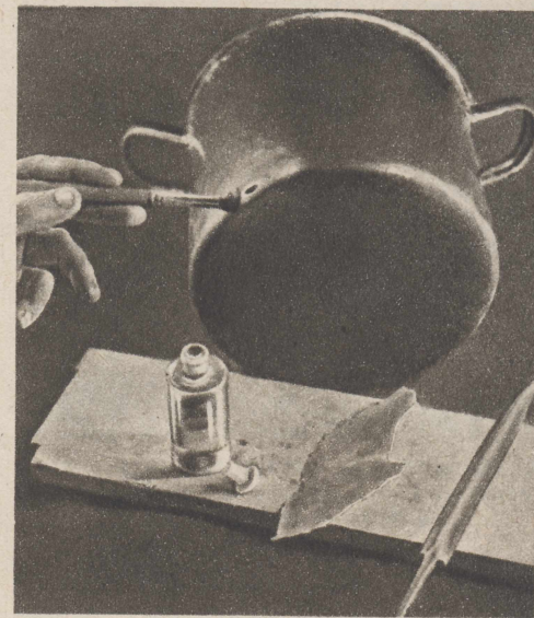
На место спая с помощью кисти наносят протраву.
