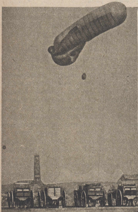
«Воздушный наблюдательный пункт» — змейковый аэростат — поднимает в воздух корзину с наблюдателями.
