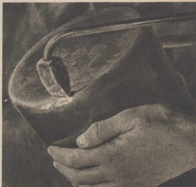
С помощью паяльника припой переносится на спаиваемую поверхность.
