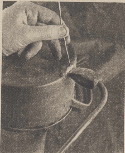
Горячим паяльником заплатка прижимается к кастрюле.
