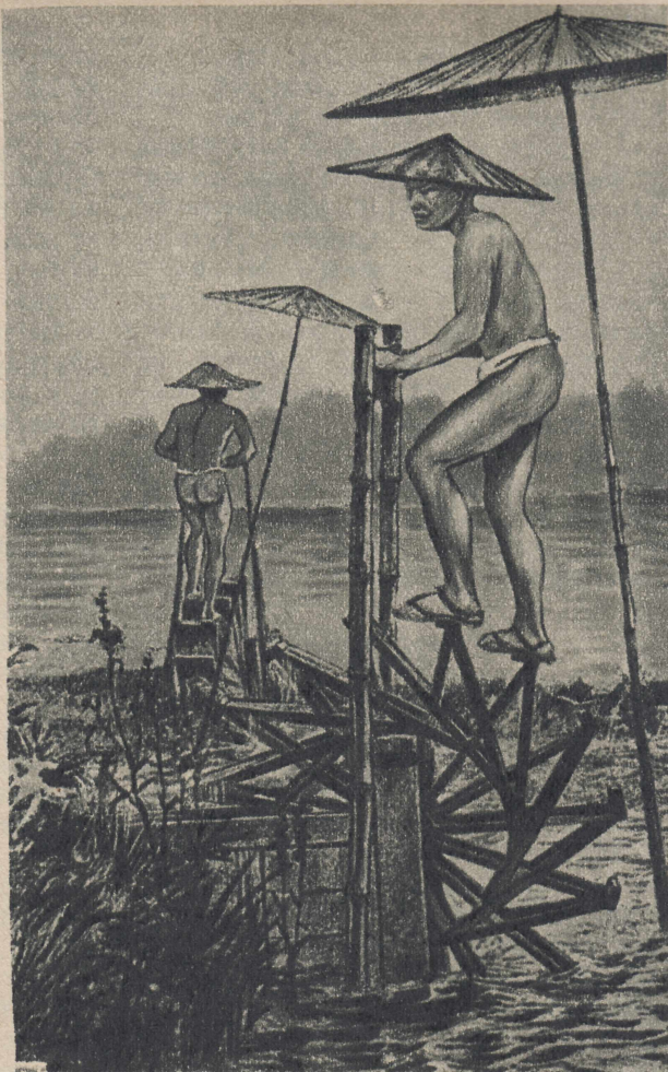
Крестьянин приводил колесо во вращение, переступая с лопасти на лопасть.
