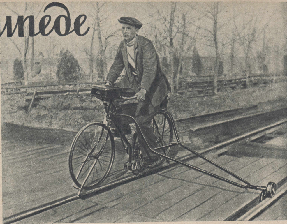
На этом велосипеде помещается целая магнитная лаборатория, проверяющая рельс на ходу.
