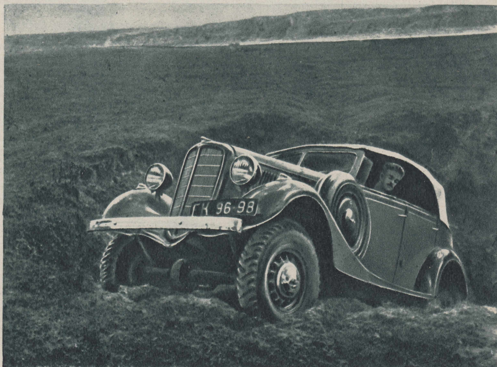
На этом снимке ясно видно, что передняя ось автомобиля «ГАЗ-61» является ведущей, как и задняя.
