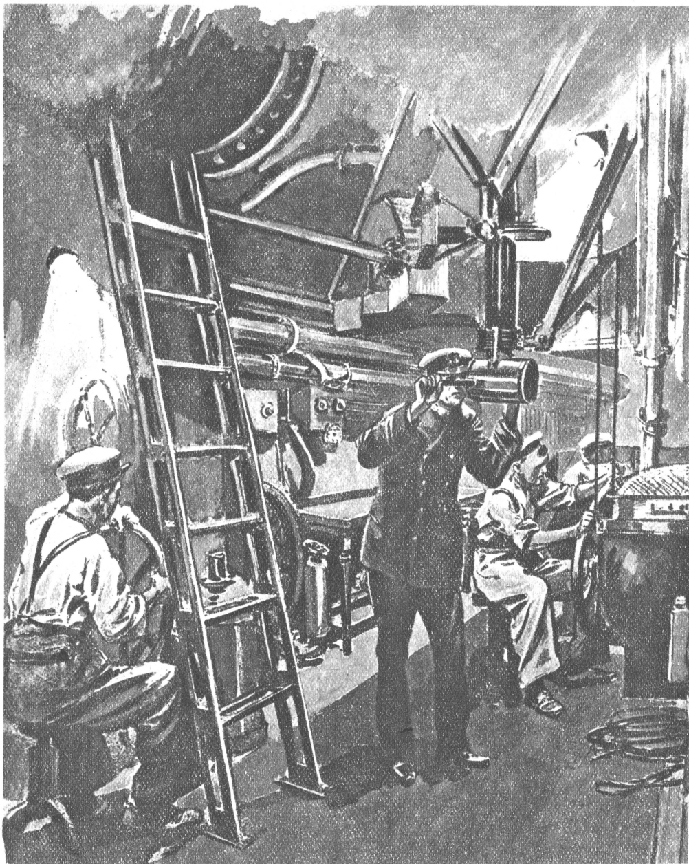
Центральный пост управления на английской подводной лодке. Командир наблюдает в перископ за поверхностью моря.
