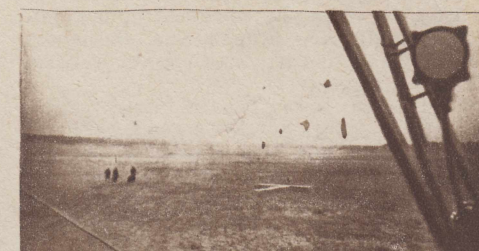
Между самолетом и землей остается всего 1 м... Совсем близко посадочное «Т». Самолет идет параллельно земле — «выдерживает». Сейчас пилот действует одной ручкой, плавно опуская хвост машины для приземления на три точки.
