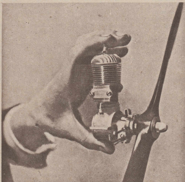
Миниатюрный моторчик весом в 100—200 г может развивать мощность в 0,2 л. с., т. е. выполнять работу одного-двух человек.
