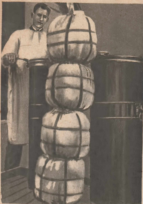
Эти четыре больших мешка содержат пороховой заряд для одного только выстрела из 356-миллиметрового орудия. Мешки перевозятся в специальных герметически закрываемых цилиндрах, чтобы порох не терял своих свойств.
