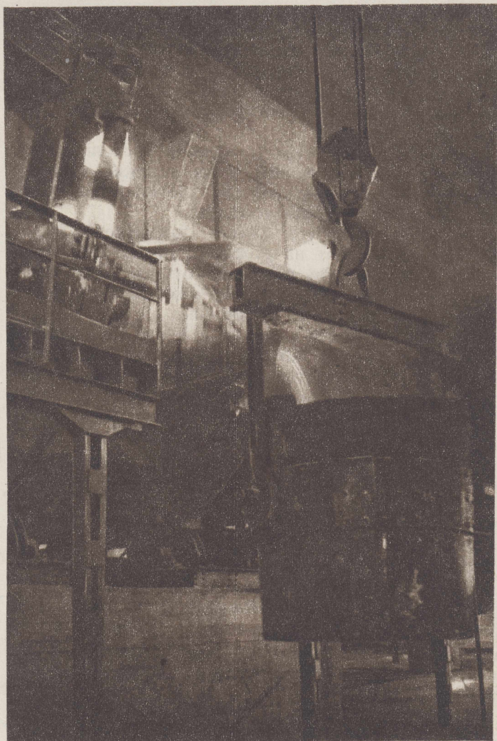
Здесь заснят момент выплавки электростали на заводе инструментальных сталей. Печь в наклонном положении видна слева. На этом заводе два электросталеплавильных цеха. В одном цехе работает 9 электропечей, а во втором 2, самые мощные в Союзе — 30-тонные. Годовая производительность цехов — 200 тысяч тонн высококачественных инструментальных сталей.
