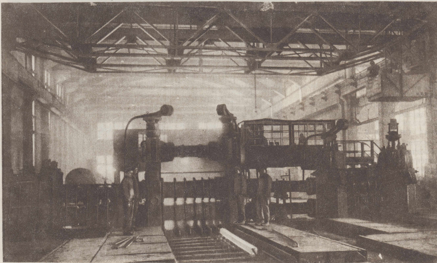
Это обжимной стан 750 миллиметров, установленный в прокатном цехе Запорожстали. Раскаленная полоса стали проходит последовательно через ряд «ручьев» и обжимается до нужных размеров.
